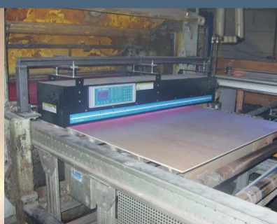
Sensor zur Leimauftragserkennung
